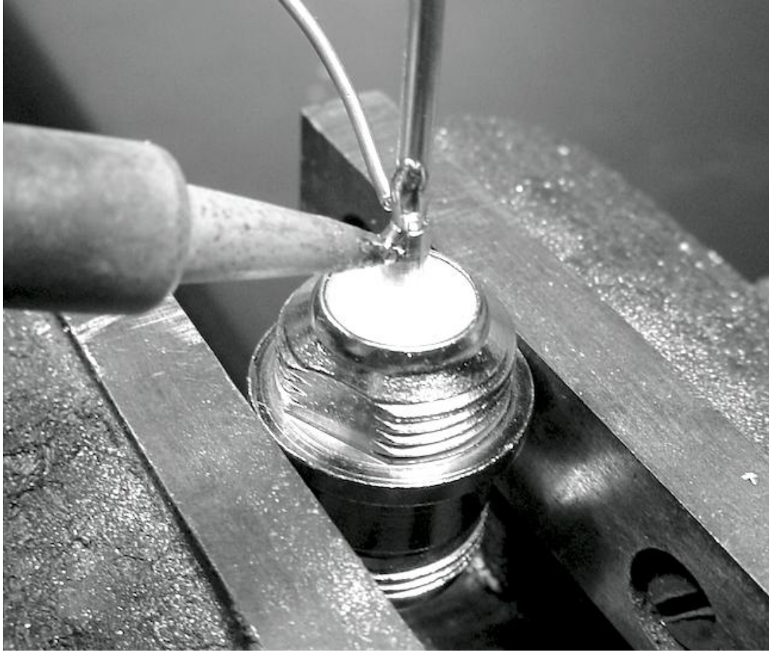
ပုံ AC 26: N connector ၏ ရွှေရောင်ခွက်ထဲသို့ ဝါယာကြိုးအား ဂဟေဆော်၍ ထည့်ပါ။
