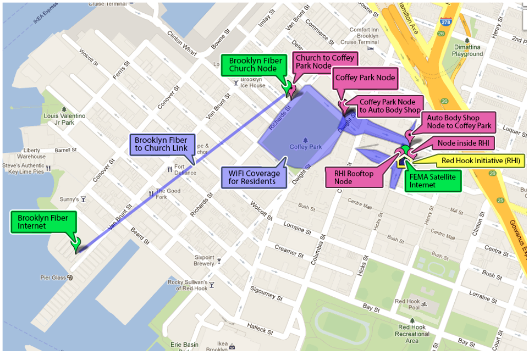
ပုံ CsOTI 15 : RHI WiFi ကွန်ယက်၏ မြေပုံ။ Google maps 2013 ကို အခြေခံထားသည်။
