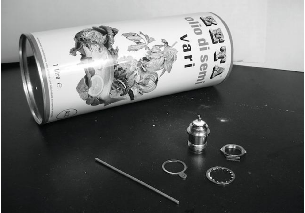
ပုံ AC 21: စည်သွပ်ဗူးဖြင့် ပြုလုပ်ထားသည့် ကောင်းကင်တိုင်(cantenna) တစ်ခုအတွက် လိုအပ်သော အစိတ်အပိုင်းများ
