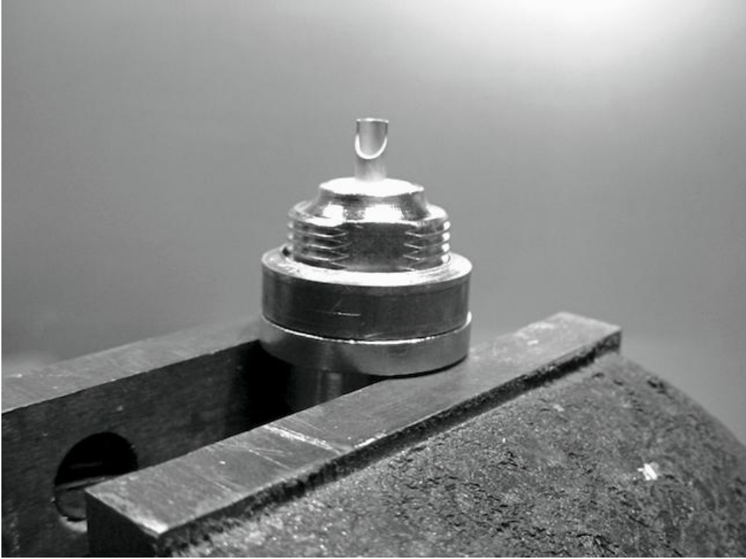
ပုံ AC 11: ကောင်းကင်တိုင်အတွက် လျှပ်စီးကြောင်း ဟန့်တားမှုသည် (50) Ohms နှင့် ကိုက်ညီစေရန် ကြေးနီပိုက် ကြားခံကို ထည့်သွင်းပေးပါ။
