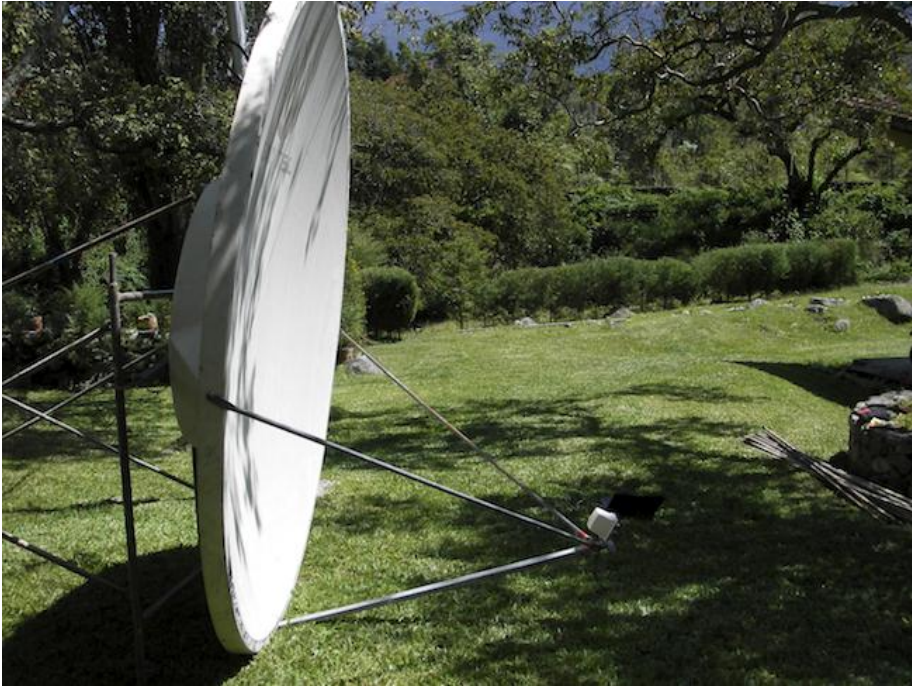
ပုံ CsLD 4 : 12 dBi ကောင်းကင်တိုင် တစ်ခုနှင့် ၎င်း၏ ဗဟို၌ 2.4 m offset fed reflector တစ်ခု ၊ (၁၄) ဒီဂရီ နိမ့်ချထားသည်။ ရေပြင်ညီ အမှတ်သည် ၈ ဒီဂရီ မြင့်တက်နေသည်။
