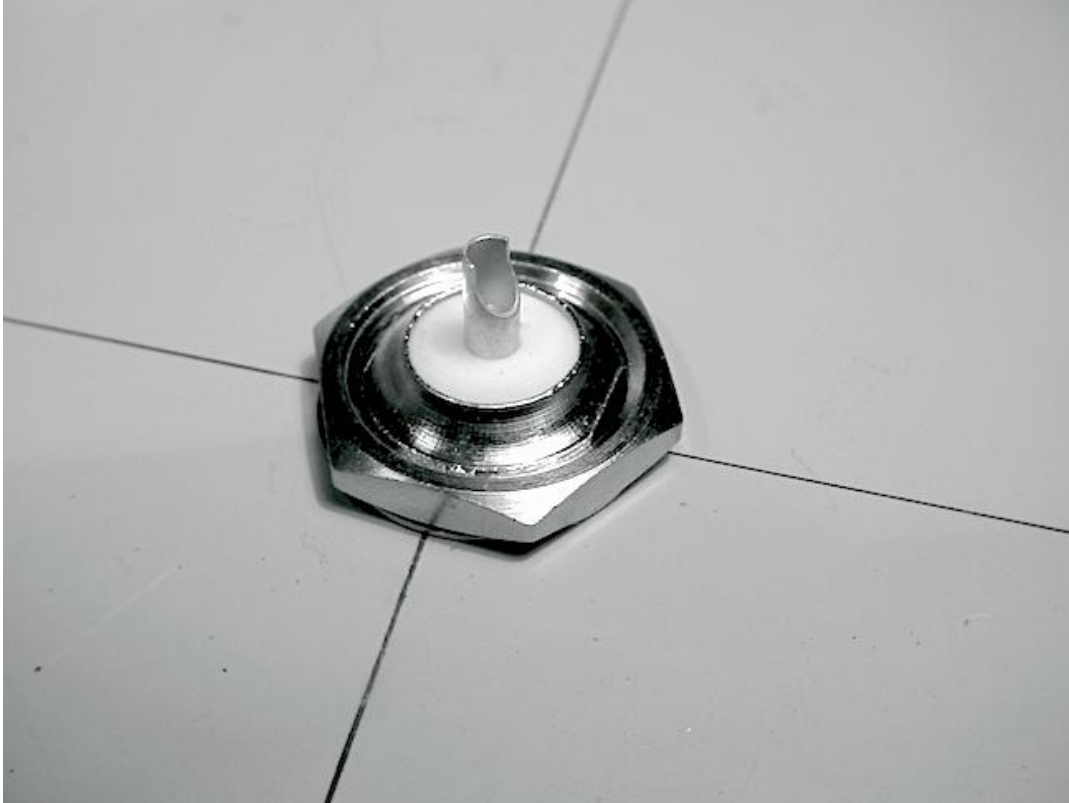
ပုံ AC 12: N connector အား သတ္တုပြားတွင် အသေအချာ မြဲမြံနေပါစေ။
